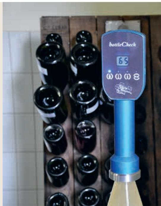
**DER BOTTLECHECK** ermöglicht es, die Gärung in Sektflaschen zu überprüfen ohne den Inhalt zu zerstören.
